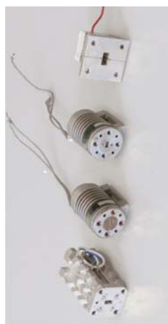
Генераторы с широким диапазоном электрической перестройки частоты на основе биполярных транзисторов и варакторных диодов со сверхрезким переходом.
