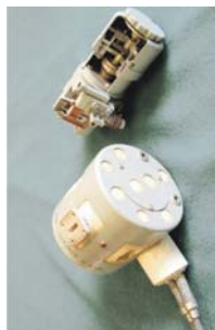
КРИСТАЛЛИННЫЙ ГЕНЕРАТОР С ПАРАМЕТРИЧЕСКОЙ СТАБИЛИЗАЦИЕЙ ЧАСТОТЫ
