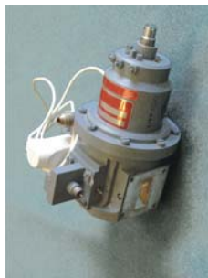
КРИСТАЛЛИННЫЙ ГЕНЕРАТОР С КОМБИНИРОВАННОЙ СТАБИЛИЗАЦИЕЙ ЧАСТОТЫ
