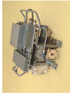
МОЩНЫЕ УМНОЖИТЕЛЬНО ПРЕОБРАЗОВАТЕЛЬНО-УСИЛИТЕЛЬНЫЕ КИ СВЧ ДЛЯ БОРТОВОЙ АППАРАТУРЫ
