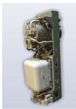
ВЫСОКОСТАБИЛЬНОЕ МАЛОШУМЯЩЕЕ МАЛОГАБАРИТНОЕ ГЕНЕРАТОРНО-ПРЕОБРАЗОВАТЕЛЬНО-УСИЛИТЕЛЬНОЕ КИ СВЧ
