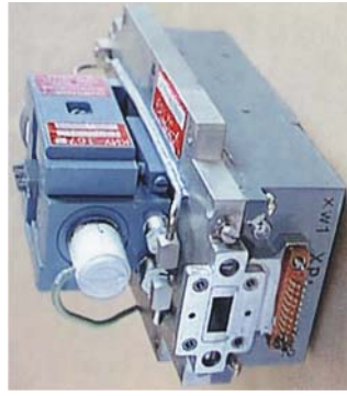
ПЕРЕДАЮЩЕЕ КИ СВЧ СРЕДНЕЙ МОЩНОСТИ ДЛЯ БОРТОВОЙ АППАРАТУРЫ
