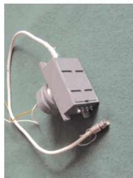
ТРАНЗИСТОРНЫЙ ГЕНЕРАТОР С ПАРАМЕТРИЧЕСКОЙ (ДИЭЛЕКТРИЧЕСКИМ РЕЗОНАТОРОМ) СТАБИЛИЗАЦИЕЙ ЧАСТОТЫ
