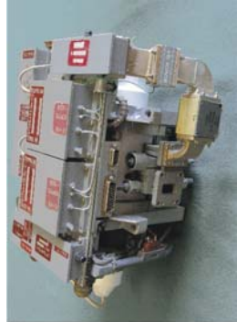
ЗАДАЮЩЕЕ ГЕНЕРАТОРНО-ПРЕОБРАЗОВАТЕЛЬНО-УСИЛИТЕЛЬНОЕ КИ СВЧ
